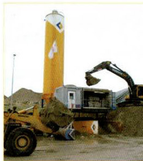
^ Trisoplast, een mengsel van zandbentoniet, bentoniet en een polymeer wordt ter plekke geproduceerd.
