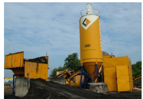
Mobiele menginstallatie op projectlocatie.
